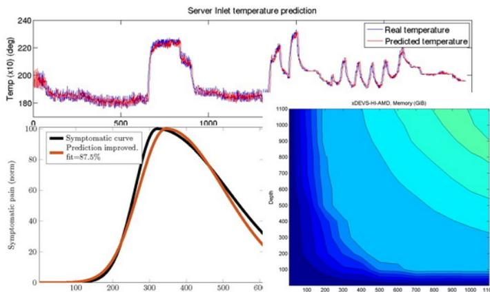
Ejemplos de modelos obtenidos en casos reales. De arriba a abajo: (1) modelo predictivo de temperatura de inlet de un servidor, (2- izquierda) modelo predictivo de crisis de migrañas (2-derecha) modelos elaborados para evaluar el rendimiento de distintos simuladores.
