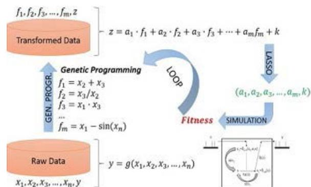
*Visión específica de la metodología. La fase de selección de rasgos se resuelve con programación genética y algoritmos de regresión. Junto con la simulación de los modelos podemos recurrir a un bucle tratando de mejorar el modelo y a su vez (o a posteriori) optimizar los parámetros del sistema real*
